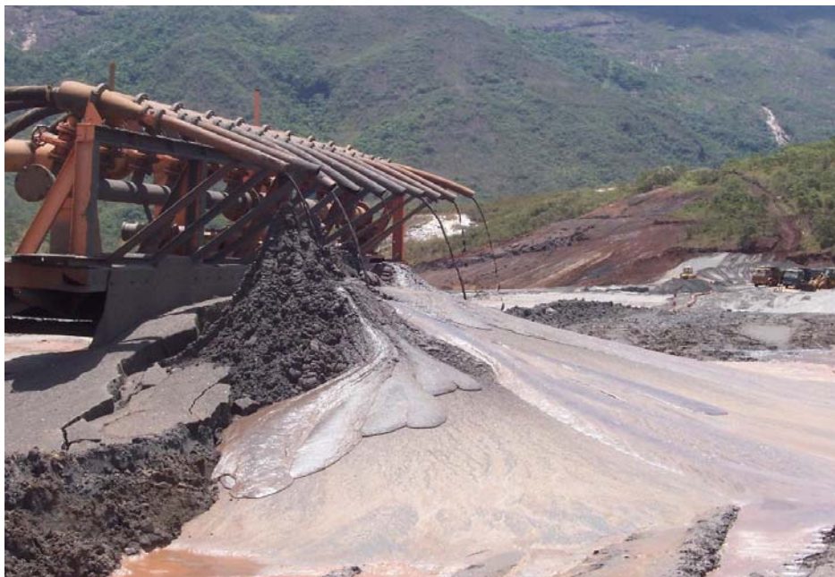
Figura 3.5 – Disposição de rejeitos pela técnica de cicloneamento (hidrociclones)
