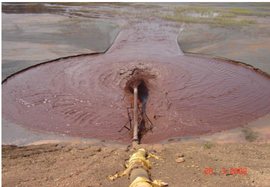
Figura 3.7 – Disposição de rejeitos pela técnica de espigotamento
