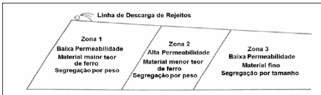
Figura 3.8 – Segregação hidráulica num depósito de rejeito de minério de ferro (Santos, 2004)
